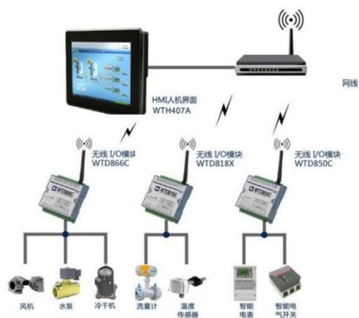
图2-26 HMI连接监控方式
