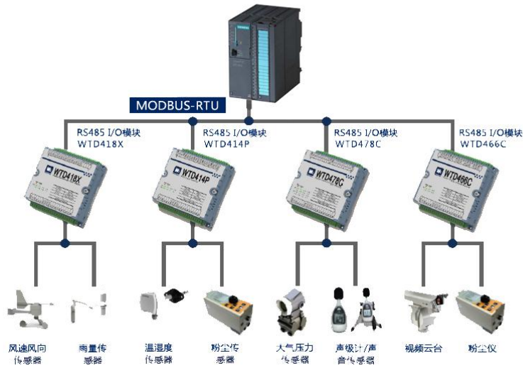
图2-7 PLC连接监控方式
