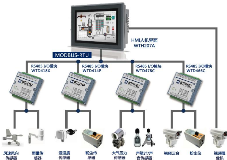
图 2-8 HMI 连接监控方式
