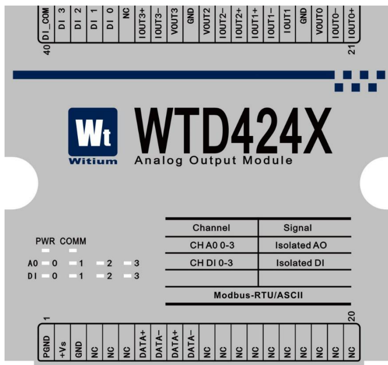
图 3-17 WTD424X 端子引脚定义
